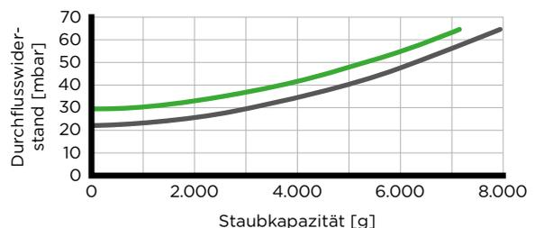
■ Mit Sekundärelement ■ Ohne Sekundärelement
