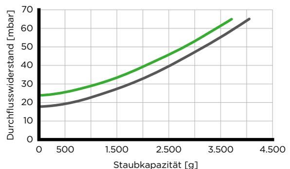
■ Mit Sekundärelement ■ Ohne Sekundärelement
