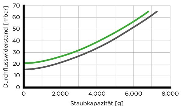
■ Mit Sekundärelement ■ Ohne Sekundärelement
