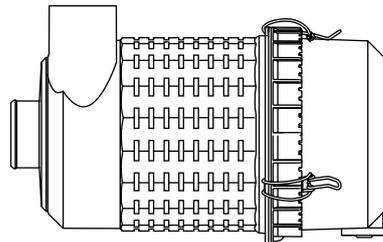
Die Funktionstüchtigkeit der Vorabscheidung ist uneingeschränkt gegeben. Der Staub wird zuverlässig im Sammelbehälter abgeschieden und von Zeit zu Zeit manuell ausgeleert. Die Wartungsintervalle hierfür richten sich nach den Einsatzbedingungen.
