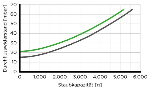
■ Mit Sekundärelement ■ Ohne Sekundärelement
