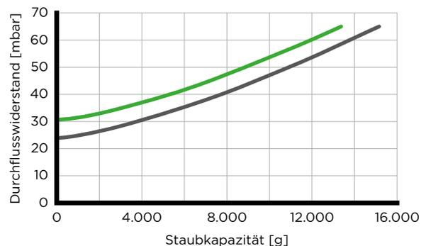
■ Mit Sekundärelement ■ Ohne Sekundärelement
