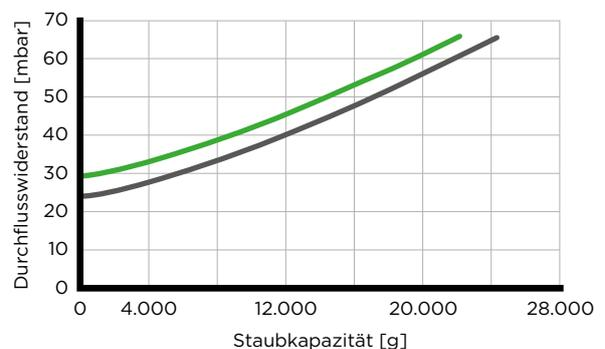
■ Mit Sekundärelement   ■ Ohne Sekundärelement
