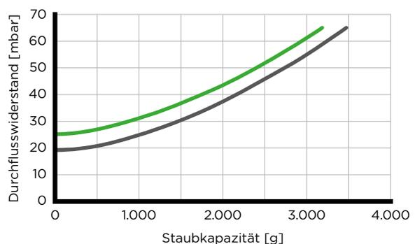
■ Mit Sekundärelement ■ Ohne Sekundärelement
