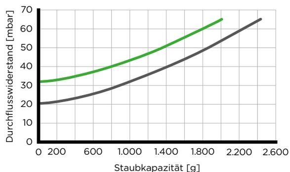
■ Mit Sekundärelement ■ Ohne Sekundärelement
