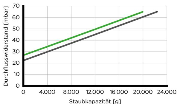
■ Mit Sekundärelement ■ Ohne Sekundärelement
