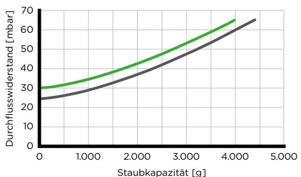
■ Mit Sekundärelement ■ Ohne Sekundärelement
