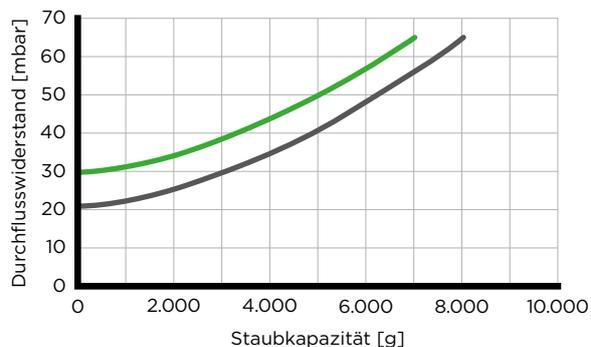
■ Mit Sekundärelement ■ Ohne Sekundärelement
