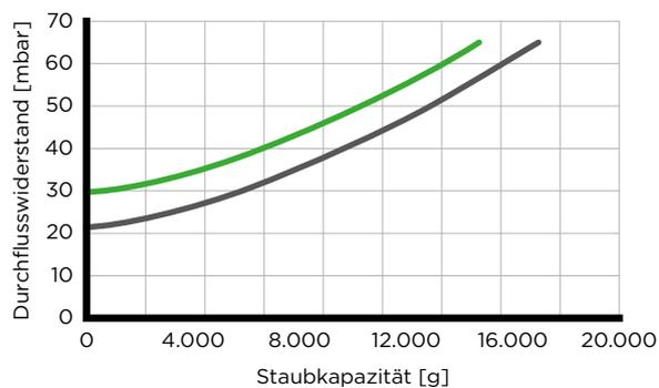
■ Mit Sekundärelement ■ Ohne Sekundärelement
