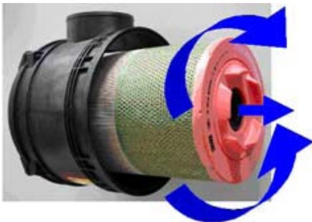
Bild 2: Hauptelement entnehmen
