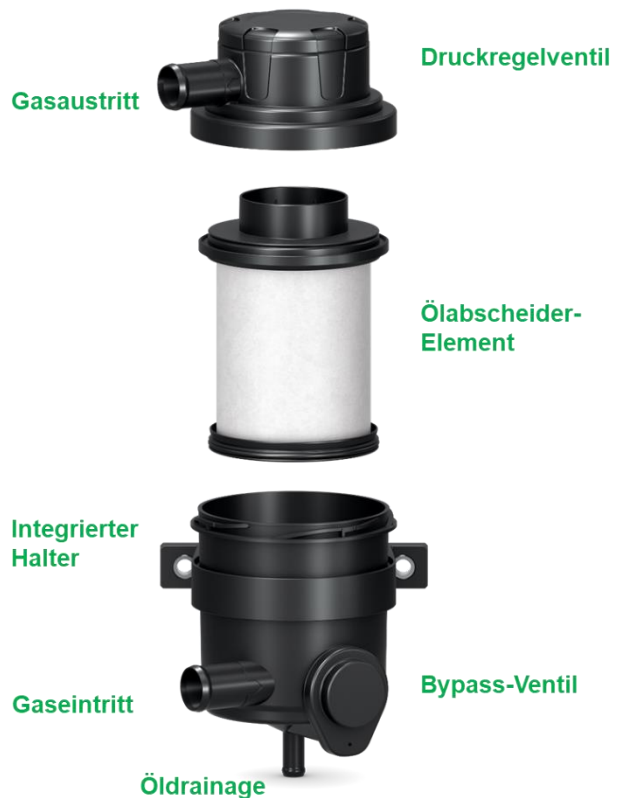
Abb. 2: Aufbau ProVent² 100
